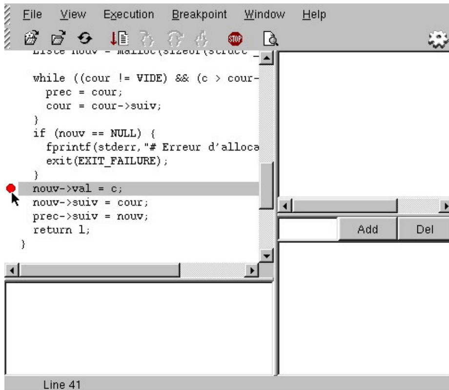
Un point rouge apparaît en regard de la ligne pour indiquer la présence du point d'arrêt. Pour supprimer un point d'arrêt, il suffit de sélectionner la ligne du code source devant laquelle il apparaît et de cliquer à nouveau sur le bouton **stop** (ou de cliquer directement sur le point rouge).
