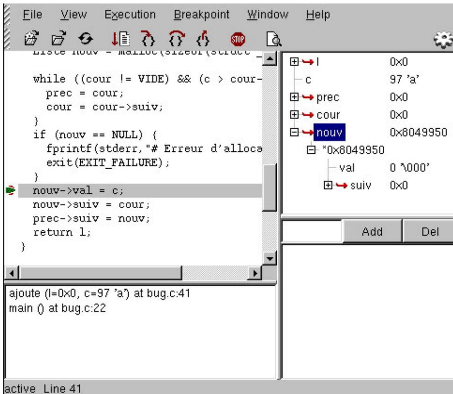
Dans la partie supérieure gauche de la fenêtre, le triangle indique la ligne avant l'exécution de laquelle le programme est arrêté (il est ici superposé au point rouge indiquant le point d'arrêt). Dans la partie inférieure gauche, `kdbg` indique le contexte d'appel des fonctions (comme la commande `bt` de `gdb`, mais sans les #).
